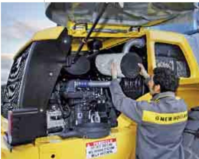
La W130B está diseñado para disfrutar de un mantenimiento y unos procedimientos de servicio fáciles y sencillos gracias a su excelente acceso desde el suelo a los componentes más importantes ya la nueva pantalla digital de alta tecnología situada en el salpicadero, que permite al operador estar atento a las funciones principales de la máquina, tales como: diagnóstico del motor y de la transmisión, información de errores y mensajes de aviso.
