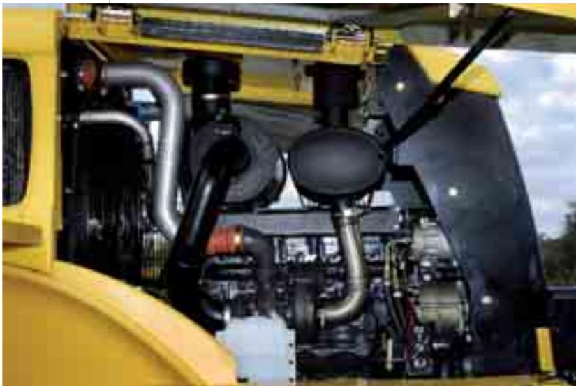
Naciones Unidas **modo de potencia automática** que se puede también seleccionar para adaptarse automáticamente la curva de potencia del motor, entre la potencia máxima y la potencia normal, a la aplicación en que trabaja la máquina.
